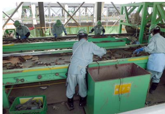
手選別作業中の様子(女川町廃棄物選別処理施設で)
